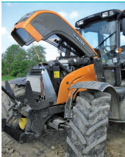
Dynamiczny 4-cylindrowy silnik Sisu o pojemności skokowej 4,4 l ma moc znamionową 124 KM/91 kW.
