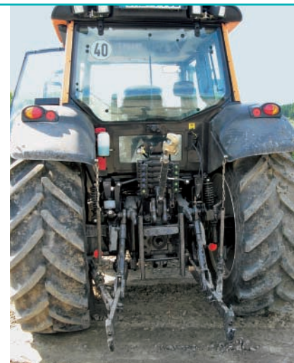
Z tyłu znajdują się cztery przyłącza hydrauliczne podwójnego działania. Udźwig wynosi 6000 daN (opcjonalnie – 8100 daN).
