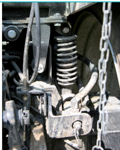
Mechaniczna amortyzacja kabiny współgra z resorowaniem osi przedniej i całą konstrukcją pojazdu.
