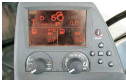
Na ekranie można kontrolować pracę przekładni i zużycie paliwa.
