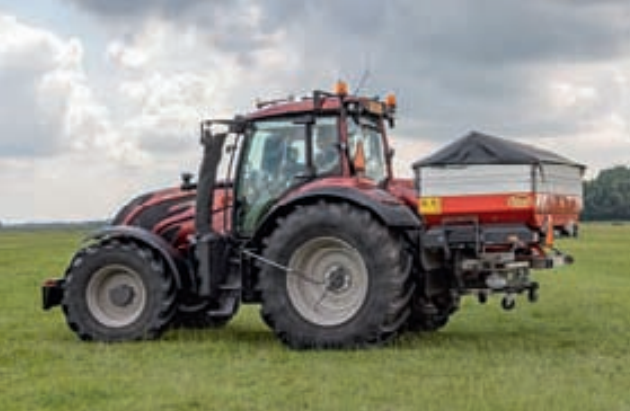
Ciągnik Valtra T174 Direct którym Thijssen pracuje, ma opony Michelin XeoBib z systemem kontroli ciśnienia zapewniającym minimalny nacisk na podłoże.
