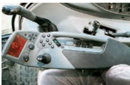
Podłokietnik z monitorem i dżojstikiem stanowi centralę sterowniczą ciągnika Valtra.
