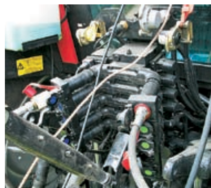
Przyłącza hydrauliczne są logicznie zgrupowane.
