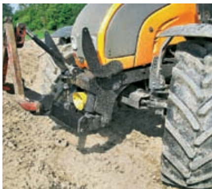
Podnośnik czołowy o udźwigu 35 kN obsługiwany jest za pomocą dżojstika umieszczonego na prawym podłokietniku.
