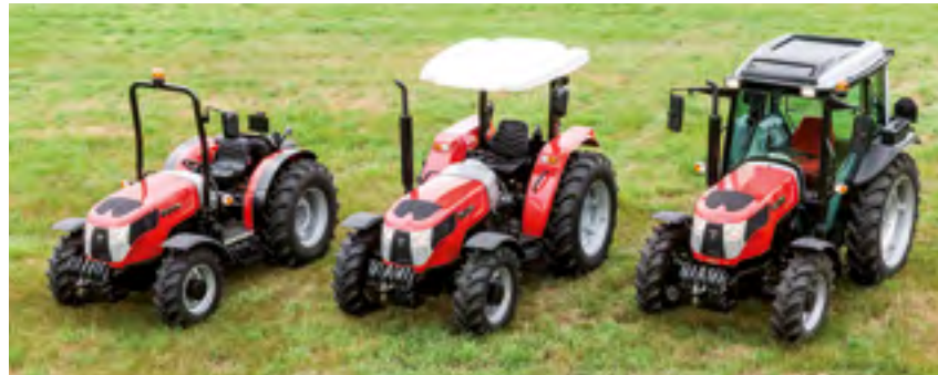
Mała seria A może być wyposażona w kabinę otwartą, kabinę z zdejmowalnym zadaszeniem lub kabinę zamkniętą.
