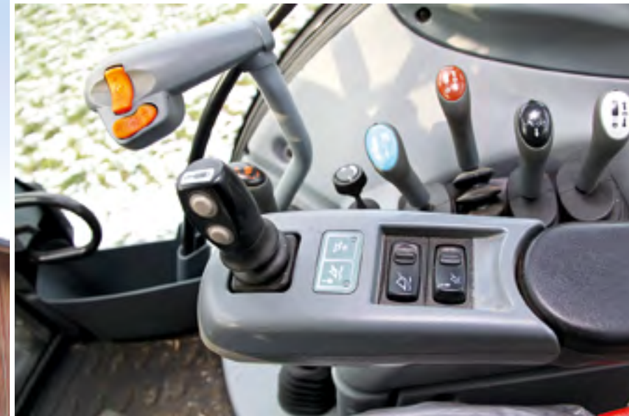
Przekładnia obsługiwana jest za pomocą dwóch przycisków.
