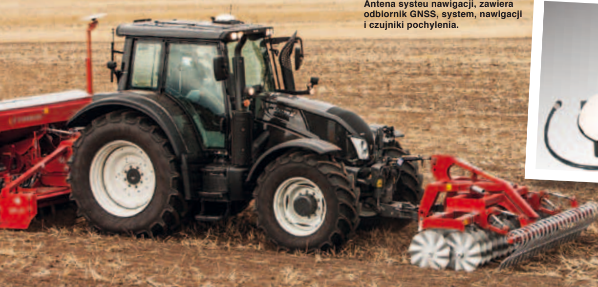
Valtra serii N z systemem nawigacji Auto-Guide 3000.
