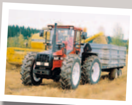
Valmet H800 był wyposażony w pełną przekładnię hydrostatyczną bez przekładni mechanicznej.
