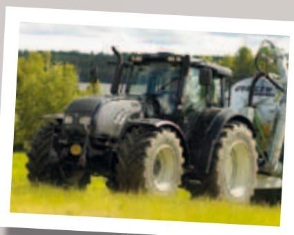
Valtra 202 wyposażona w nową przekładnię CVT o nazwie Direct, która jest kombinacją napędu mechanicznego i hydrostatycznego.
