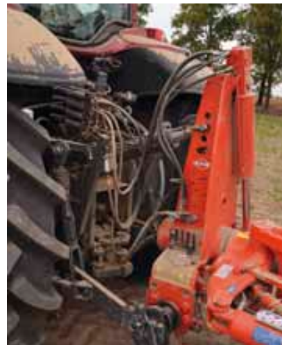
Tylny podnośnik kat. III dźwiga do 7,8 t. Sama Valtra N174 waży na pusto 6,5 t. Maksimum dociążenia pozwala uzyskać wagę do 7,5 t.
