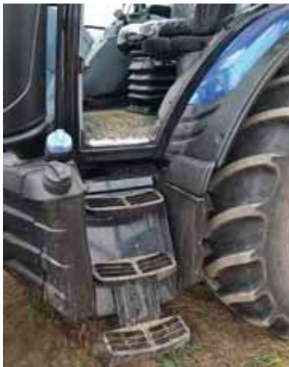
Schody do kabiny są ustawione pod większym kątem, aby bezpiecznie wchodzić do kabiny.
