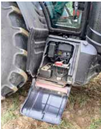
W nowej generacji Valtry serii N prawa pokrywa odchyła się w dół, odsłaniając dostęp do akumulatora, bezpieczników oraz półki na skrzynkę narzędziową.
