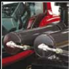
Podłączenie akcesoriów do systemu za pośrednictwem szybkozłącza.
