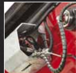
Przewody środka smarnego mogą być zabezpieczone dodatkową osłoną.
