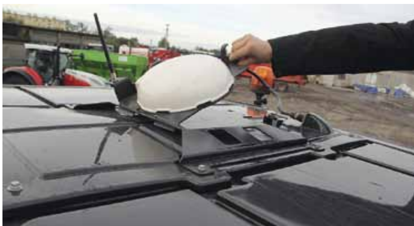
System prowadzenia przez sygnał GPS wymaga zainstalowania anteny na dachu ciągnika. Valtra ma do tego celu dedykowane miejsce w dachu. Antenę montuje się na zatrzask.
