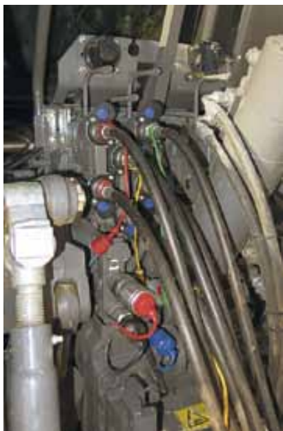
Testowana Valtra S-374 miała 4 pary tylnych złączy hydraulicznych.
