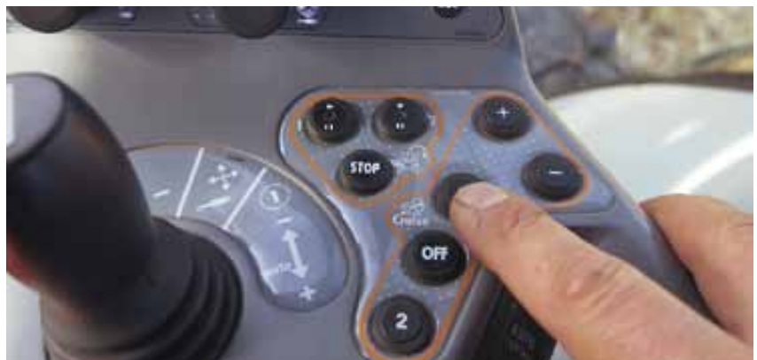
Ciągnik ma przekładnię bezstopniową, co pozwala, a nawet obliuguje do korzystania z tempomatów. W zależności od rodzaju wykonywanej pracy możemy ustawić równe obroty silnika albo prędkość ciągnika. Możemy także wybrać do pracy oba tempomaty. Nastawioną prędkość silnika jak i ciągnika można korygować dodatkowymi przyciskami + i -.
