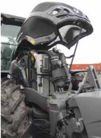
Maskę otwiera się przyciskiem zamka, który możemy zabezpieczyć kluczykiem – tym samym, którym uruchamia się silnik. Pokrywa silnika unosi się łatwo, umożliwiając to silownikowi gazowe.
