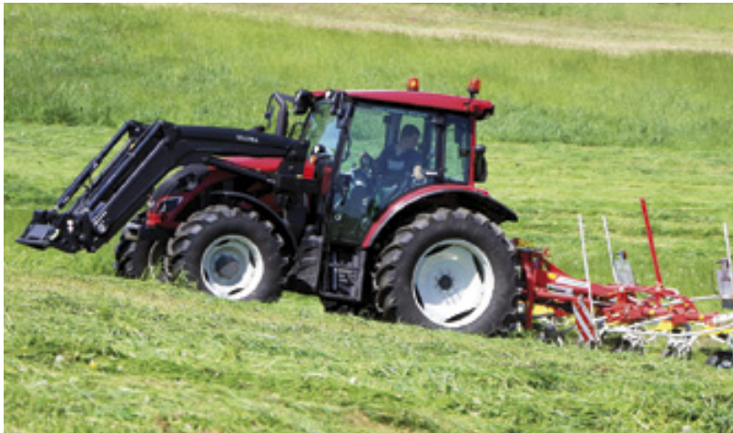
Valtra A104 z silnikiem czterocylindrowym o mocy maksymalnej 100 KM i hydrauliką o wydatku 98 l/min.
