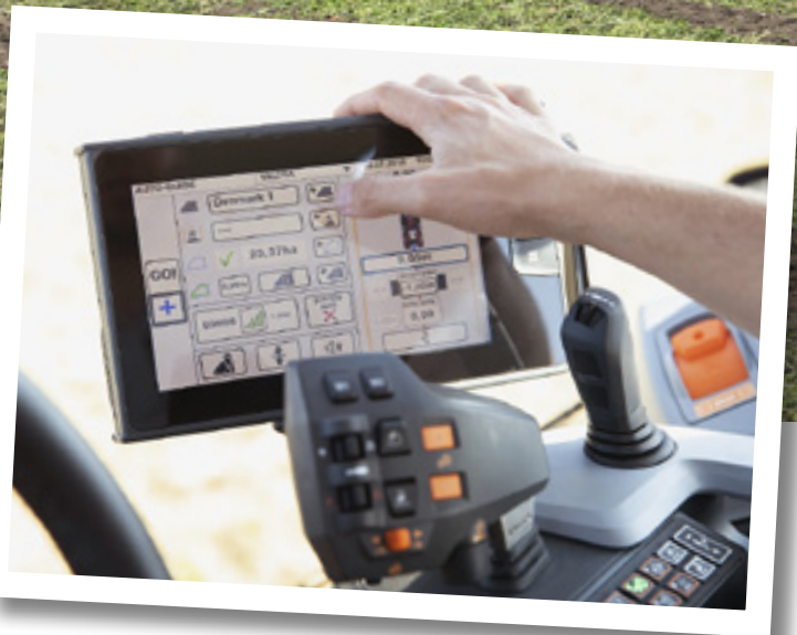
Automatyczny układ prowadzenia Auto-Guide jest kluczowy w koncepcji rolniczej firmy DanRoots, gdyż pozwala ciągnikom i kombajnom na jazdę wzdłuż tych samych linii.
