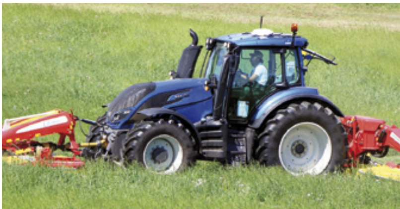
Valtra T174 z silnikiem sześciocylindrowym o pojemności 7,4 l o mocy maksymalnej 190 KM.
