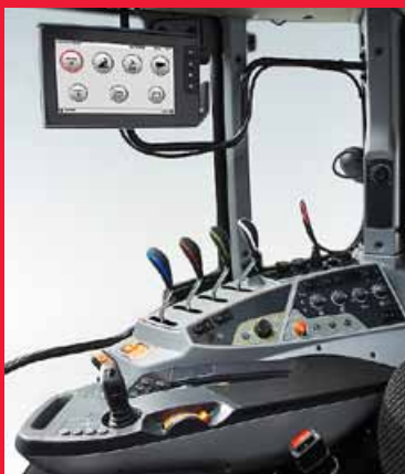
Po lewej: Modele HiTech i Active w ciągnikach serii N oraz T są teraz dostępne i korzystają z tego samego interfejsu użytkownika, co modele SmartTouch. Terminal pozwala na obsługę funkcji rolnictwa precyzyjnego, takie jak automatyczne prowadzenie AutoGuide.
