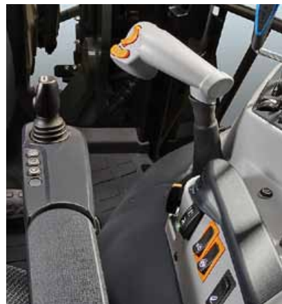
Łatwa zmiana biegów dzięki ergonomicznej dźwigni i przełącznikom kołyskowym.
