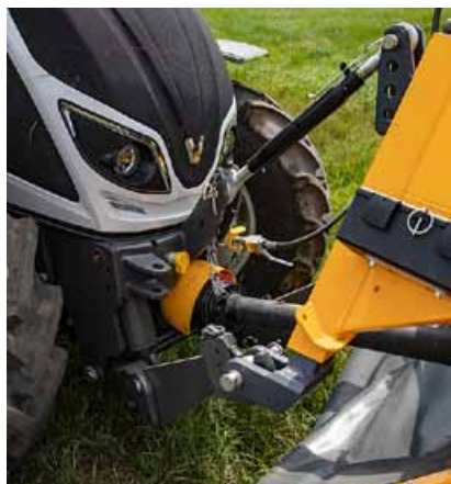
Nową serię A można wyposażać w przedni TUZ oraz lub przedni WOM w Unlimited Studio.
