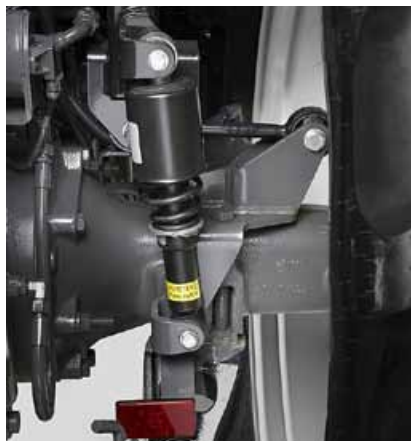
Regulowane mechaniczne zawieszenie kabiny, które składa się z podwójnych drążków Panharda do jej stabilizacji.
