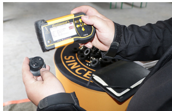
Czujnik pomiaru ciśnienia i temperatury montowany w oponie i czytnik tych parametrów.
