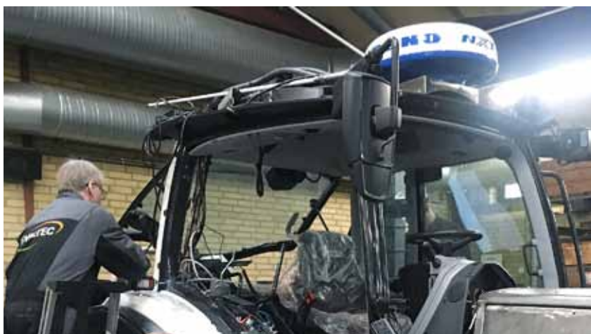
Valtra N154 to wielozadaniowy ciągnik, który można wyposażać w różne narzędzia, np. radar morski, termowizyjną kamerę na podczerwień i szperacz.
