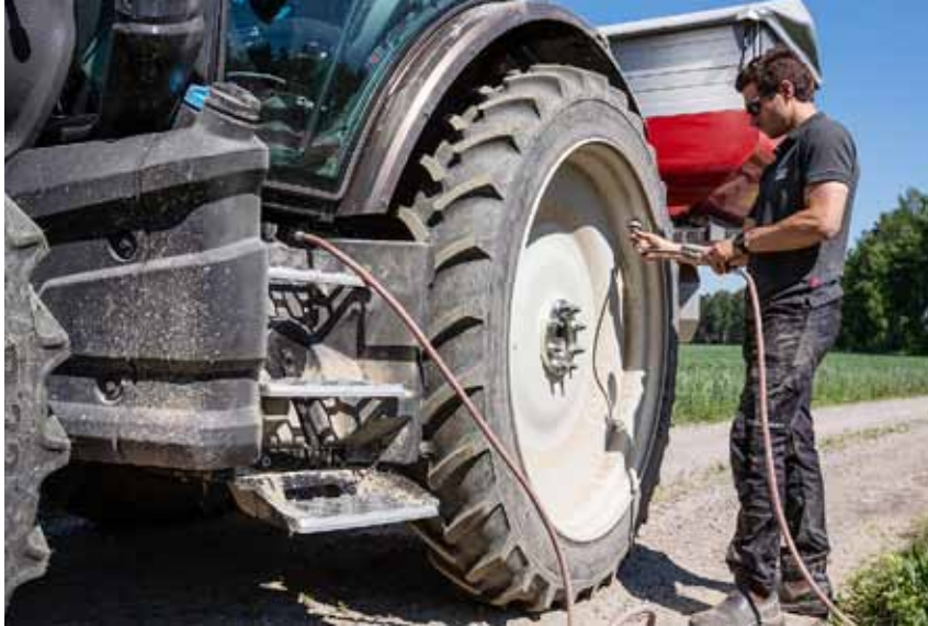
Nowa seria G jest dostępna ze złączem sprężonego powietrza z boku ciągnika przy stopniach kabiny, co ułatwia na przykład regulację ciśnienia w oponach.
